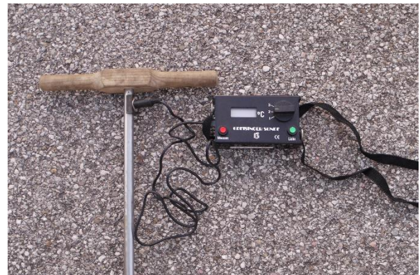
Abbildung 15: Anzeige elektrische Messsonde
